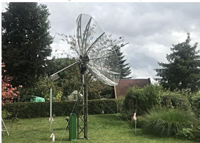
DL1SUZ má parabolu 3,2m a pracuje s TCVR Adalm Pluto a byl QRV i provozem CW
