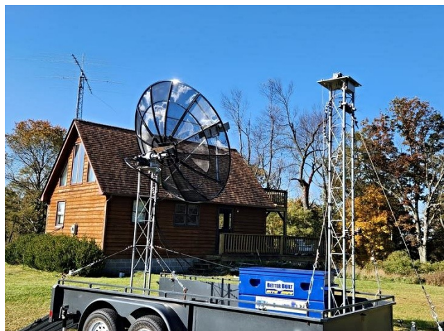
Vybavení WR8AA – 2,4m parabola, 450 W na 23cm a 4x12 el Yagi M2 a 600W na 70cm
