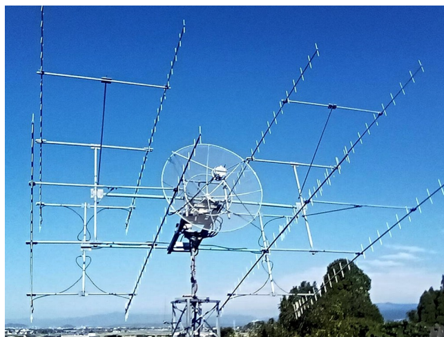
JF6CTK používá HM parabolou 1,8m a 10 W out
