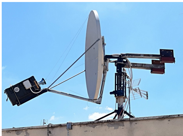
Jedním s italských účastníků závodu byl IU0BTM na 10GHz s parabolou 1,8m
