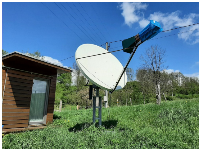
Offset parabola 1,8m na 23cm OK2AQ
