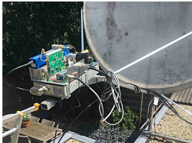
Zařízení na 24GHz PE1CKK pro pásmo 24GHz parabola 1,8m offset, PA TWT 30W a LNA DU3T
