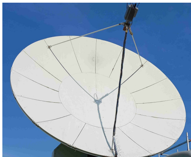
TRX OK1CA na 6cm v parabolě 4,2m při testu na slunce
