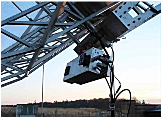
SSPA 1kW OK1DFC zavěšený na parabole
