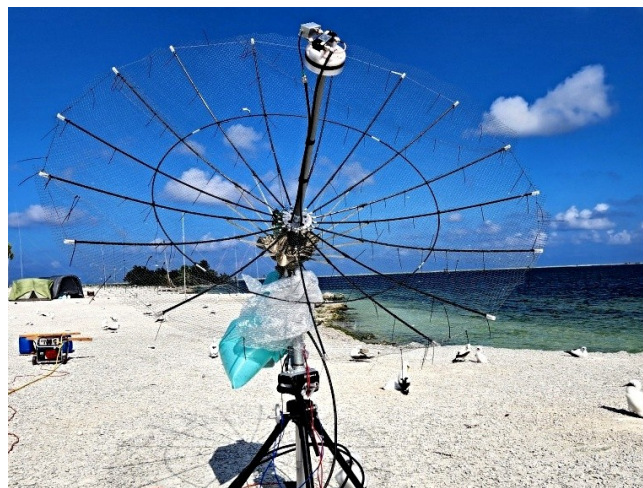
Parabola 2,4m TX5S s ozařovačem pro 1296MHz
