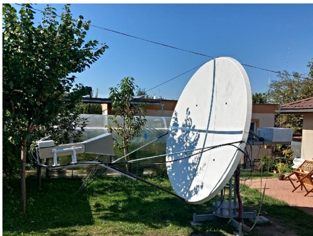
Nová parabola OM4XA s ozařovačem na 23cm
