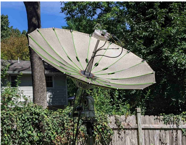
V závodě byl také QRV DK1KW se skládací parabolou 1,8m konstrukce W2HRO
